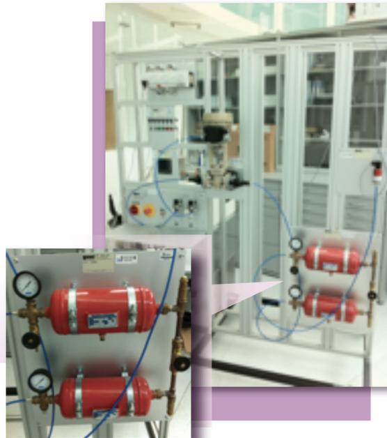
En flujo estable, donde  $\Delta p$  es constante y  $q$  es constante también, la resistencia en esta condición de operación puede obtenerse fácilmente si se dispone de una curva experimental que relacione ambas variables. En este punto de operación, la pendiente de esta recta tangente es precisamente la resistencia neumática  $R$ .
