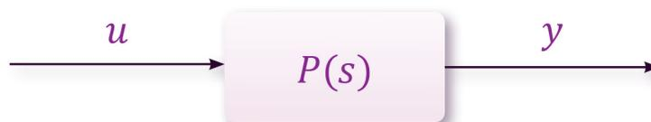
**Problema:** Identificar  $a$  y  $a$ , para  $i = 1, \dots, n$  a partir de mediciones de entrada-salida del sistema.
