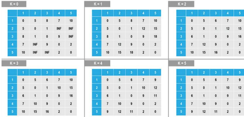
Figura 5.5 Ejemplo del algoritmo de Floyd
