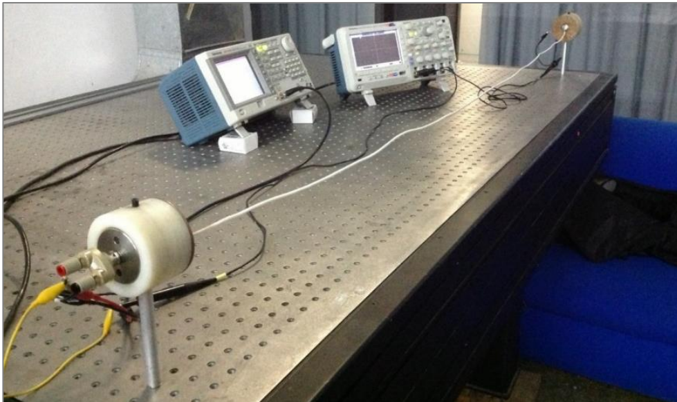
Figura 5.3. Configuración del experimento de transmisión de trenes de pulsos a través de 1.5\text{ m} de cable AWG12 con transductores con bulk integrado usados como transmisor y receptor de ondas guiadas.
