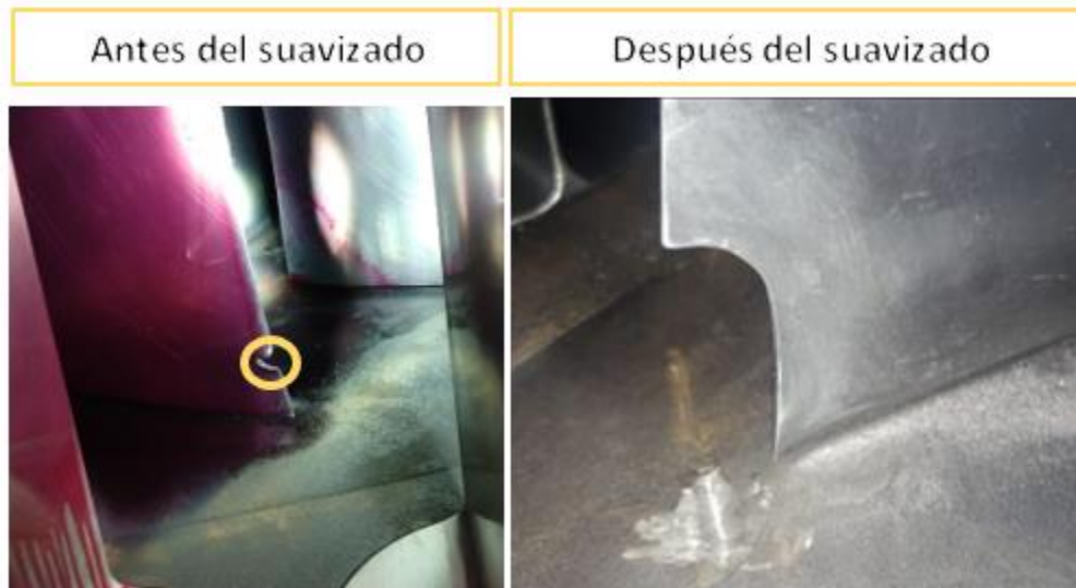
Figura 2-4 Parta del álabe dañado antes y después de haber realizado un suavizado para reparar el daño
