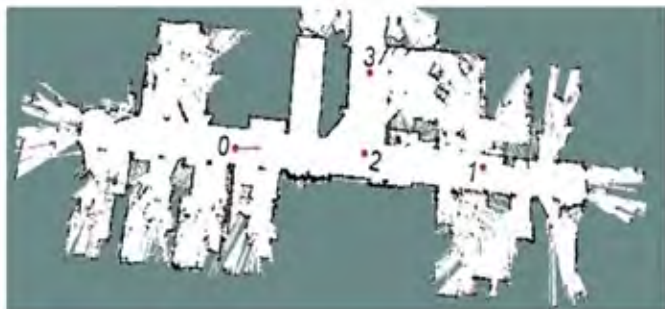
Figura 27. Ejemplo de mapa generado por SLAM.
