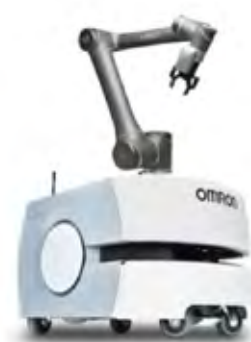
Figura 26. Robot para manejo y traslado de material (imagen propiedad de OMRON).
