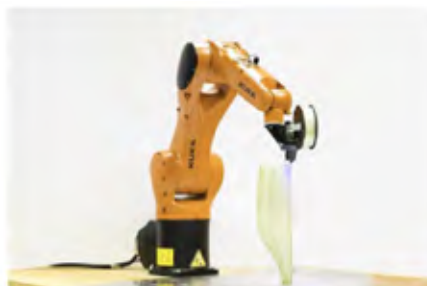
Figura 33. Robot para Impresión 3D (imagen propiedad de KUKA).
