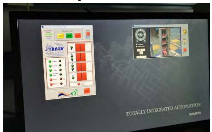
Figura 2. Pantalla donde se observa el TIA portal, la VRM y la cámara.
