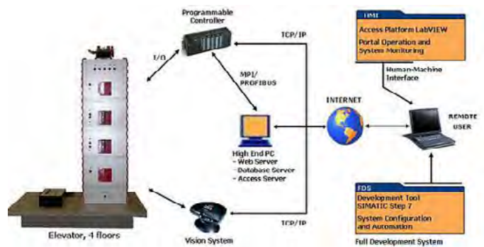
Figura 1. Diagrama a bloques del sistema de laboratorio remotos.
