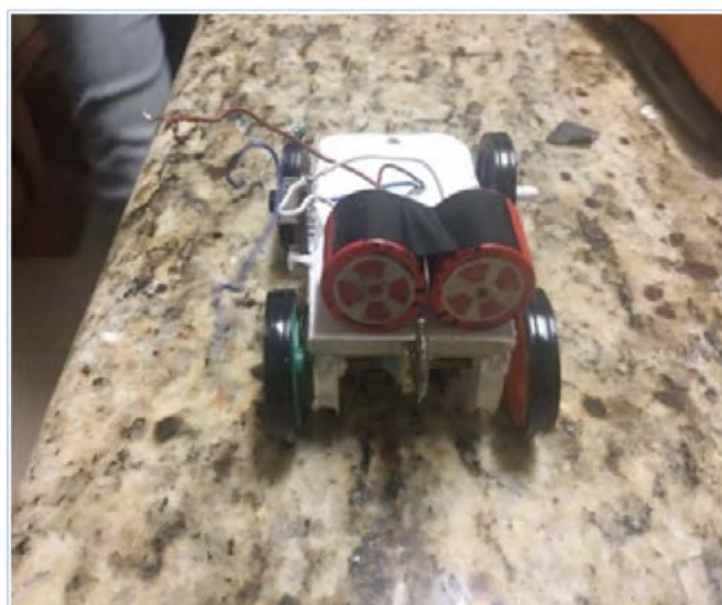
Figura 2. Carro con los capacitores
