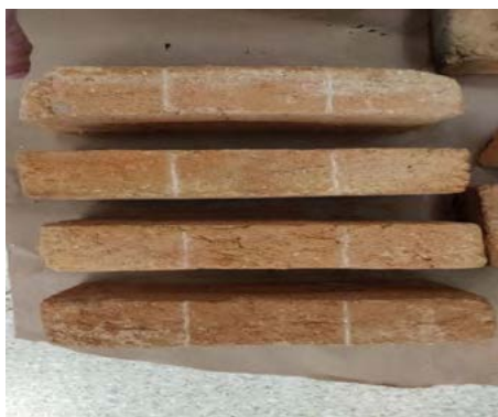
Figura 2. Prueba de daño del ladrillo con el producto Guard Construction Esquema de pruebas del producto para medir deterioro en ladrillo (probado 15 días), Equipo 4.
