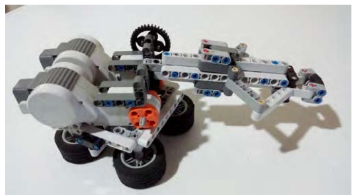
Figura 4. Manipulador serial de 2 grados de libertad construido con piezas de LEGO Mindstorms.
