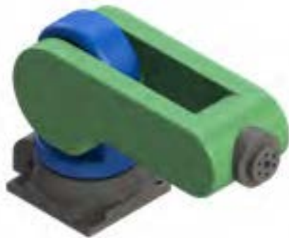
Figura 2. Ejemplo de un manipulador de 2 grados de libertad modelado en el programa Solidworks™.
