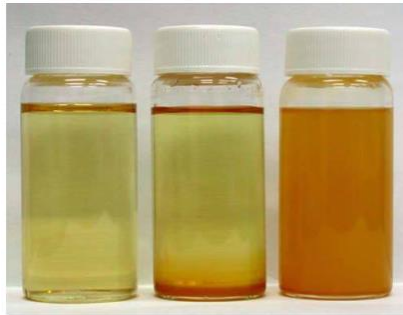
Fig. 14.14 Sedimentación de las nanopartículas de SiO 2 en parafina líquida (Peng et al. 2010a)
