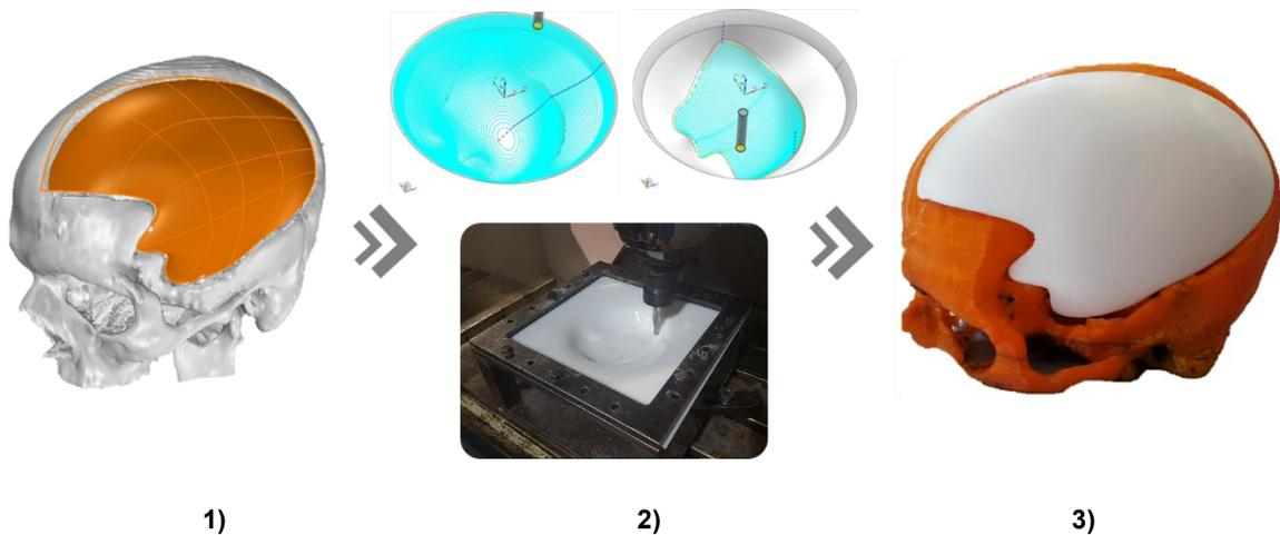
Fig. 3-7 1) Modelo 3D del cráneo y la aproximación del diseño de la prótesis (en color naranja), 2) Diseño de la generatriz, diseño de la estrategia de conformado y fabricación de la pieza, 3) Impresión del biomodelo y la presentación de la prótesis final de cráneo.
