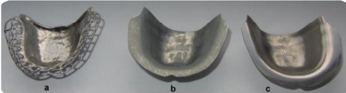
*Fig. 3-11 a) Base original, b) y c) Réplicas de la base dental fabricadas por conformado incremental mono-punto.*
