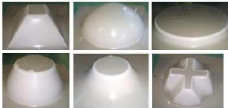
Fig. 3-14 Imágenes de algunas de las formas conformadas en la chapa de polietileno (PE). [44]
