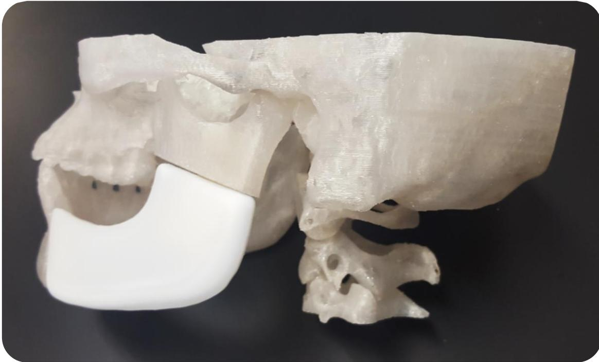
*Fig. 5-34 Presentación de la prótesis para la reconstrucción de mandíbula afectada por Ameloblastoma unicístico plexiforme. – Diseño Final (pieza BOB + Estrategia de conformado 2).*
