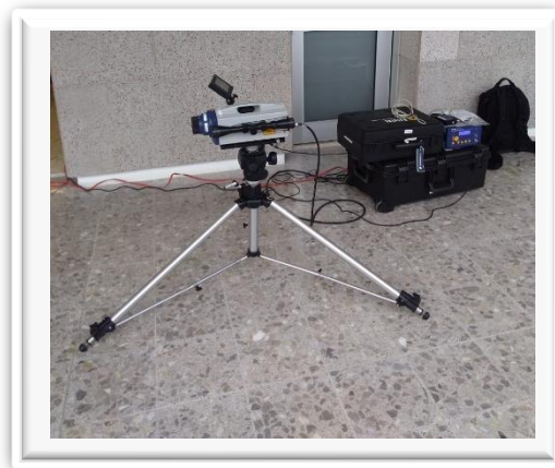
Fig. 5.14 RSV-150 laser vibrometer at Tecnológico de Monterrey campus
