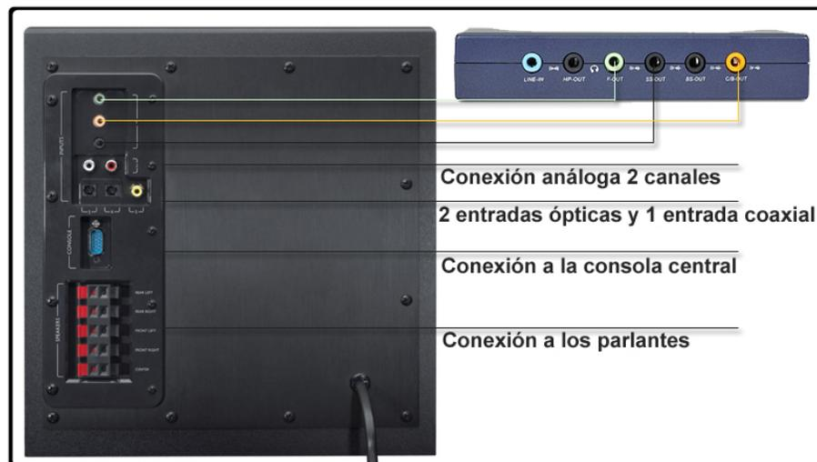
**Figura 3.7:** Imagen de las entradas del sistema de sonido Logitech z906 y como conectar la tarjeta de sonido externa Sabrent USB-SND8 al sistema.
