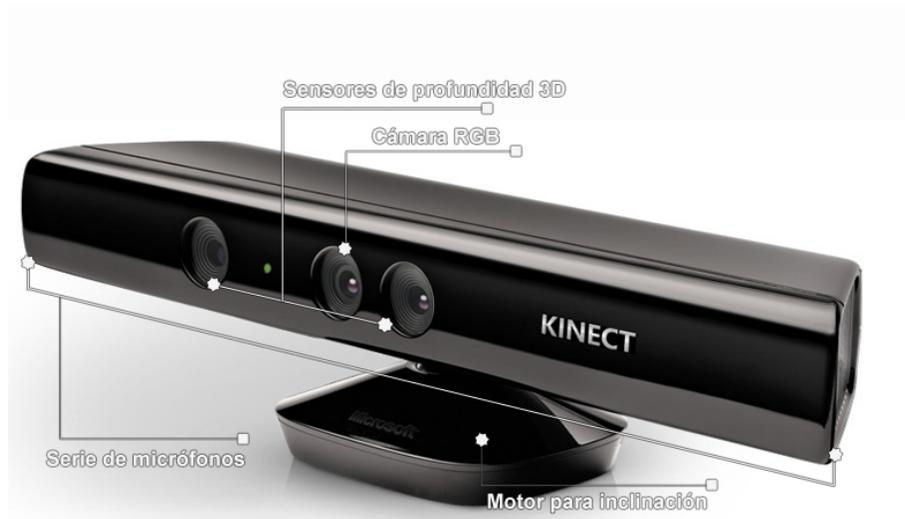
**Figura 2.4:** Elementos del Kinect.
