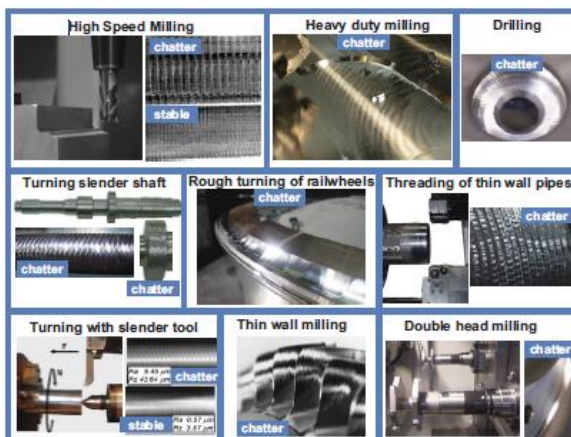
Figura. 1.3 Chatter en distintas aplicaciones de mecanizado. [1]
