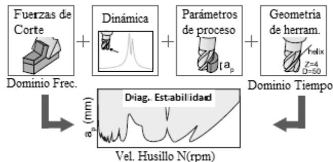
Figura 2.13 Procedimiento para obtener lóbulos de estabilidad (SLD).[42]
