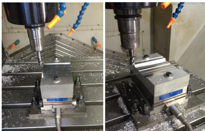
Figura 5.6. Instrumentación, mesa dinamométrica Kistler 9257B para la medición de fuerzas y pieza de trabajo de Aluminio 7075.
