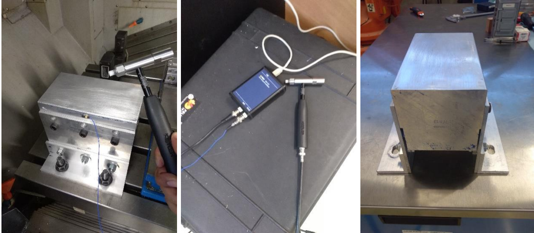
Figura 5.1. Instrumentación, diseño y montaje para pruebas modales en bloque de Aluminio 7075T6.
