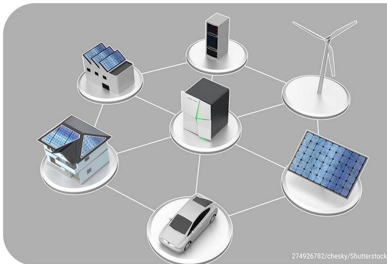
**Las unidades de almacenamiento de energía y baterías,** recolectan la energía proveniente de los generadores distribuidos para después utilizarla de manera administrada.
