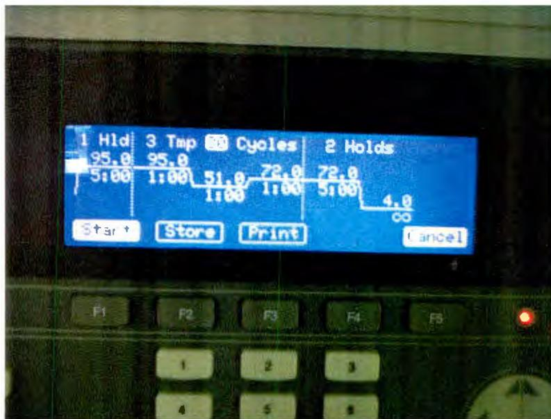
Fig. 1. Ejemplo de ciclos en la pantalla de un termociclador utilizado para el proyecto. En este caso la T<sub>m</sub> es 51°C
