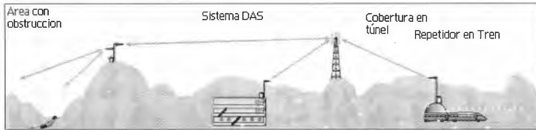
Figura 3.4 – Aplicaciones con repetidores: Carreteras, edificios, trenes [IV]
