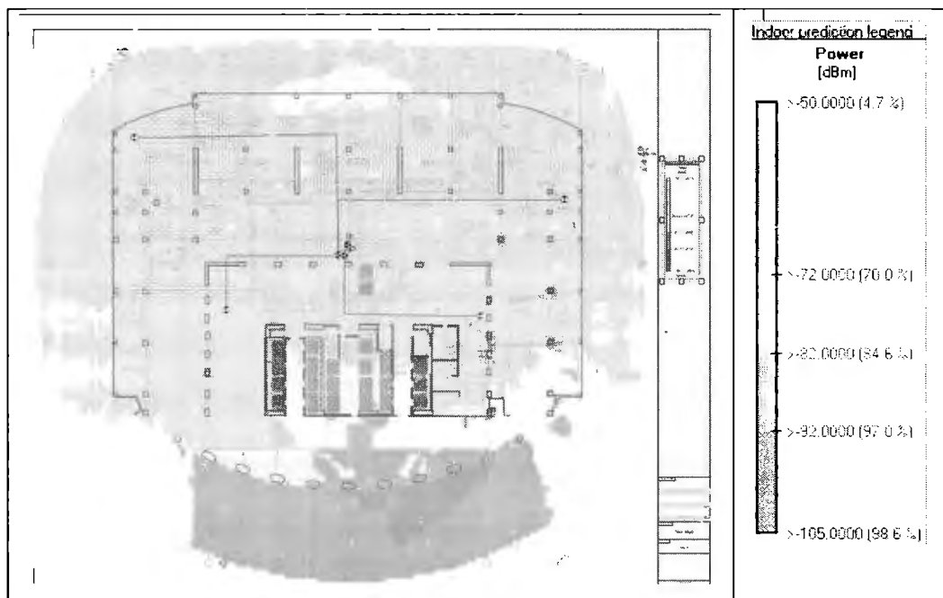
Figura 5.2 - Cobertura edificio en etapa 4 con equipo 2 Watts solo CDMA.
