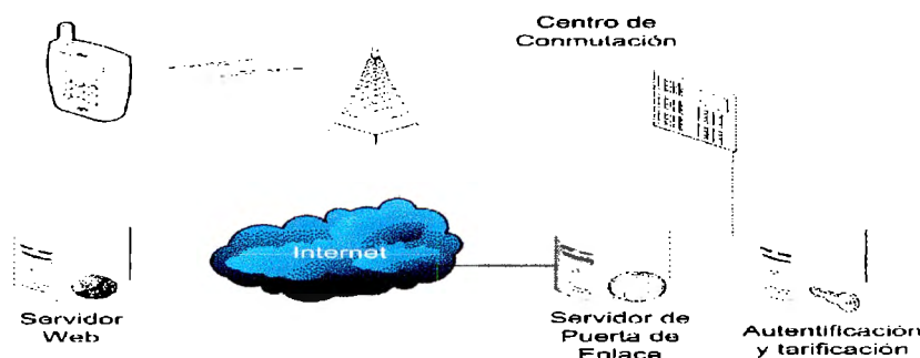
Fig. 6 Implementación de un sistema de telefonía celular
