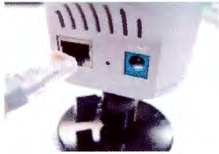
Fig. 13 Estructura física de la cámara y conexión
