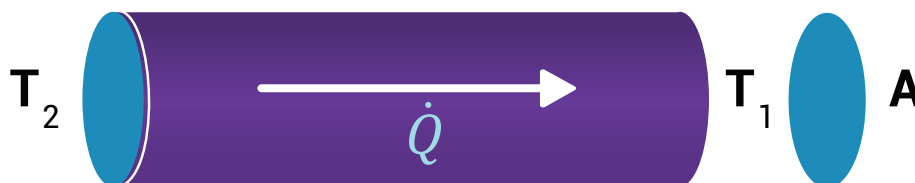
Transferencia de calor en una barra sólida de área transversal A de una T_2 a una T_1 , donde T_2 > T_1
