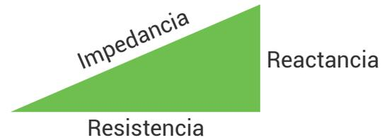
La **impedancia** (Z) de una carga está compuesta por una parte **resistiva** (R) y una parte **reactiva** (X) que puede ser inductiva o capacitiva.
