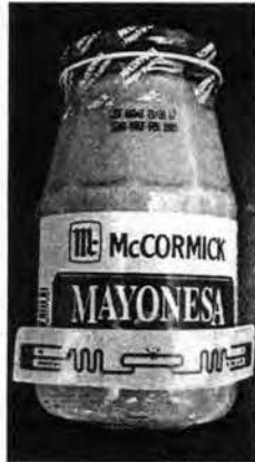
Gen2. Lectura hasta los 70cms en horizontal Ahora se describe el rendimiento de las etiquetas en una botella de vidrio vacía.
