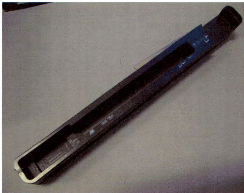
Figura 8.1h. Barra de Nylamid SL® después del maquinado. Se observa el brazo #1
