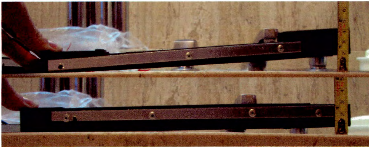
Imagen 8.1i Brazos deformados fabricados con Nylamid SL®. Al colocarlos sobre una superficie plana, se observa una deformación en el extremo de la derecha tanto del brazo 1 (arriba) como del brazo 2 (abajo). La Imagen 8.1j muestra un aumento para observar la deformación.
