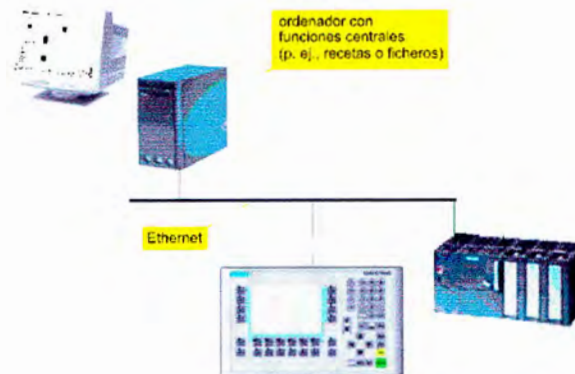
Figura 2.4.2.a. Esquema de conexiones Panel-PLC-Computadora
