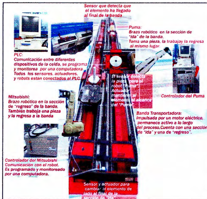
Figura 1.1.2. Componentes de la Celda de Manufactura
