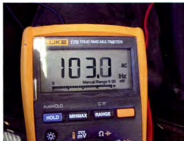
Figura 19: Visualización de la frecuencia en el multímetro
