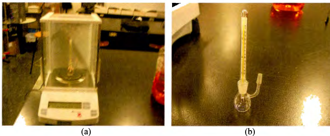
Figura 4.10 Báscula electrónica de precisión y picnómetro
