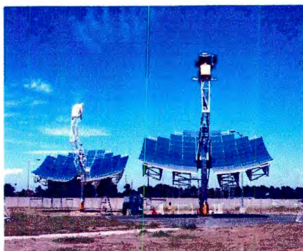
Fig. 1 → Seguidor solar a gran escala
