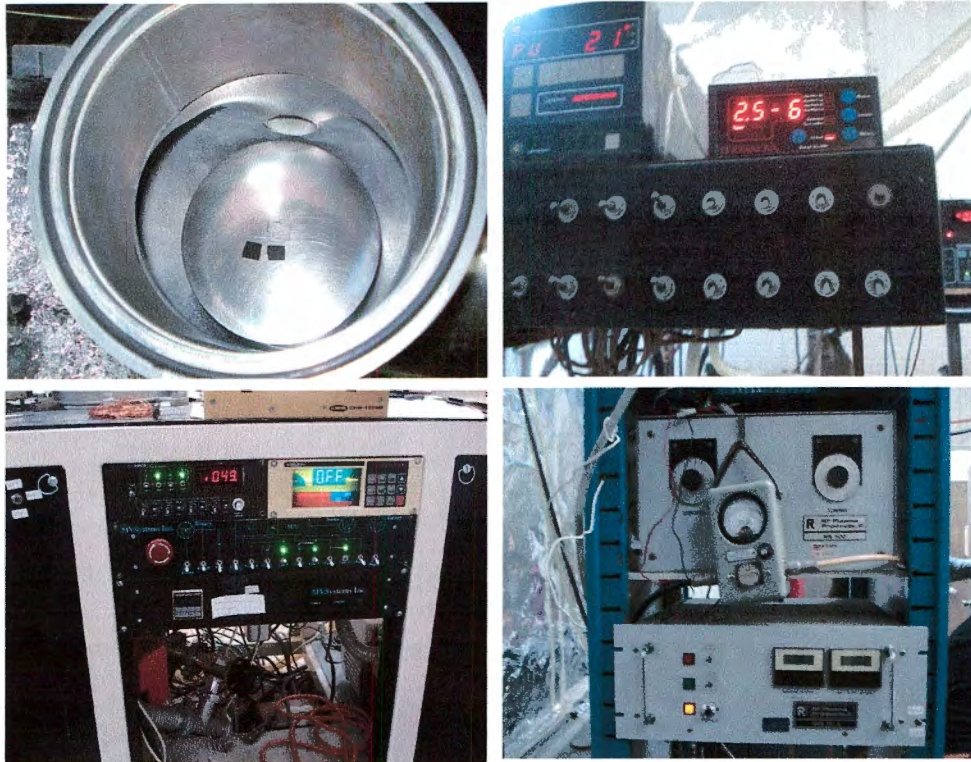
Imagen 3.9 (de izq. a der. y de arriba abajo) (a) Colocación de las muestras dentro de la cámara sobre la pieza que se mandó construir. (b) Display del sensor de presión de la bomba turbomolecular. (c) Panel de entrada y control de las variables de flujo de cada gas. (c) Sistema de excitación AC
