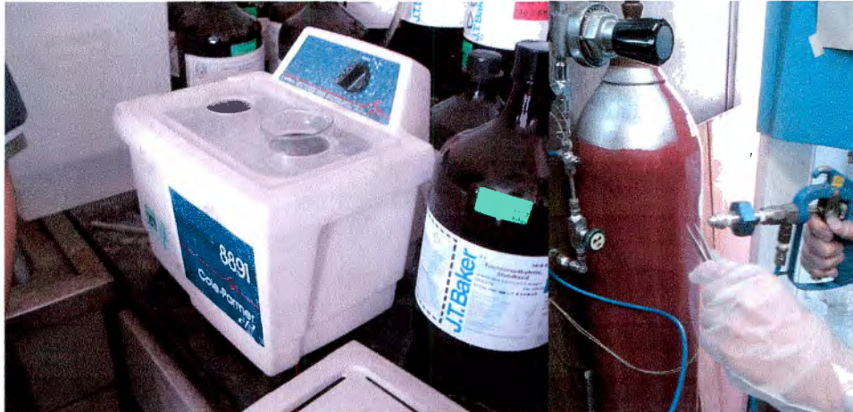
Imagen 3.8. (a) equipo de ultrasonido para la limpieza de los sustratos. (b) Limpieza de los residuos de líquidos de limpieza por medio de Nitrógeno de alta pureza.
