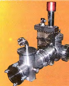
Figura 4. Segunda cámara de crecimiento armada.
