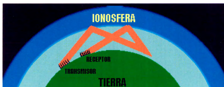
Figura 3.7 Refracción en la ionosfera 10
