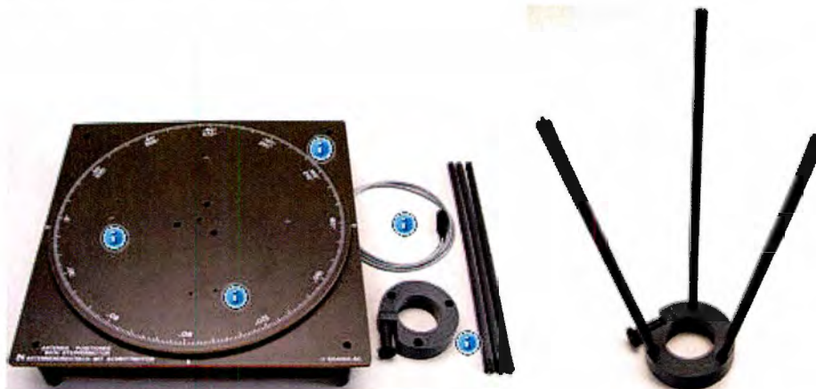
Figura 2-34 Plataforma giratoria y varillas para montaje de antenas. (Curso L@bsoft, 2006)
