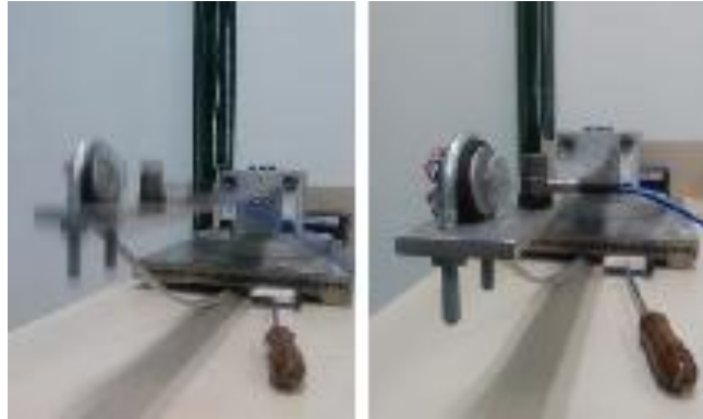
Figura 19. Sistema en resonancia (izquierda), sistema en vibración fuera de resonancia (derecha).
