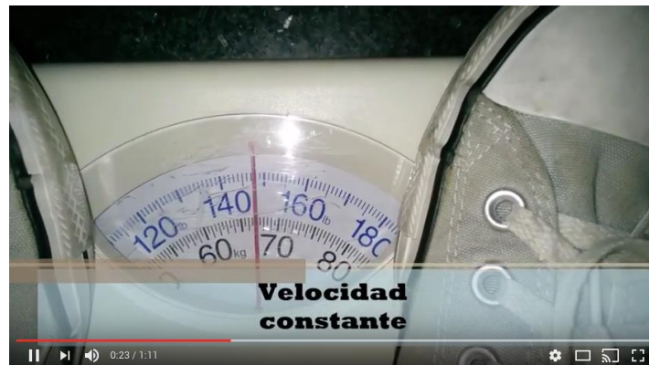
Fig. 7. Actividad experimental: peso aparente en un elevador en movimiento
