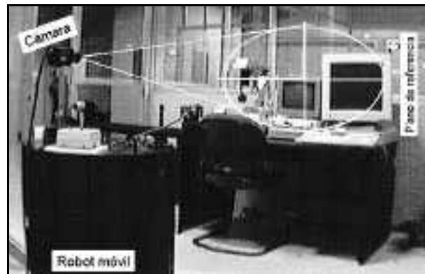
Figura 8. Arreglo experimental donde aparecen el robot con su cámara y algunos objetos de referencia sobre un escritorio.
