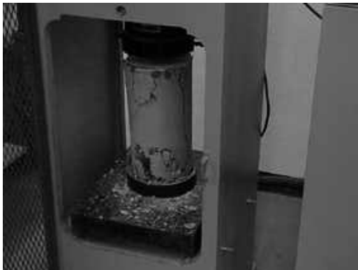
Figura 3. Ensaye de Cilindros a la Compresión.
