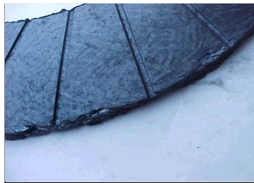
Figura 1. Disco de fricción con el defecto llamado “poro”.
