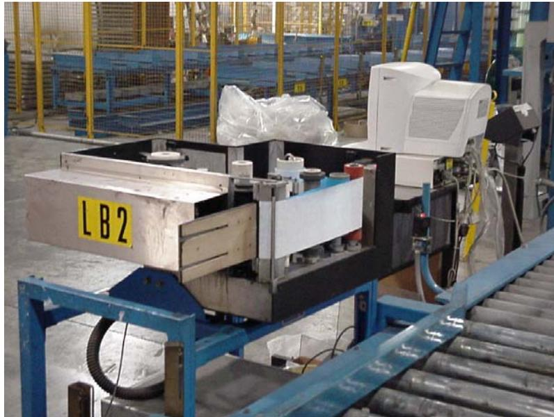
*Figura 14.- Máquina Etiquetadora / Pesadora Salmoiraghi.*
