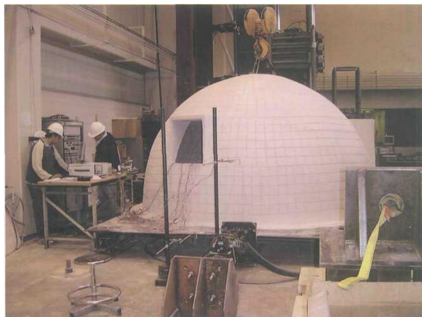
FIGURA 2 Tecnodomo sobre mesa vibratoria en laboratorio de estructuras en Texas A&M University.
