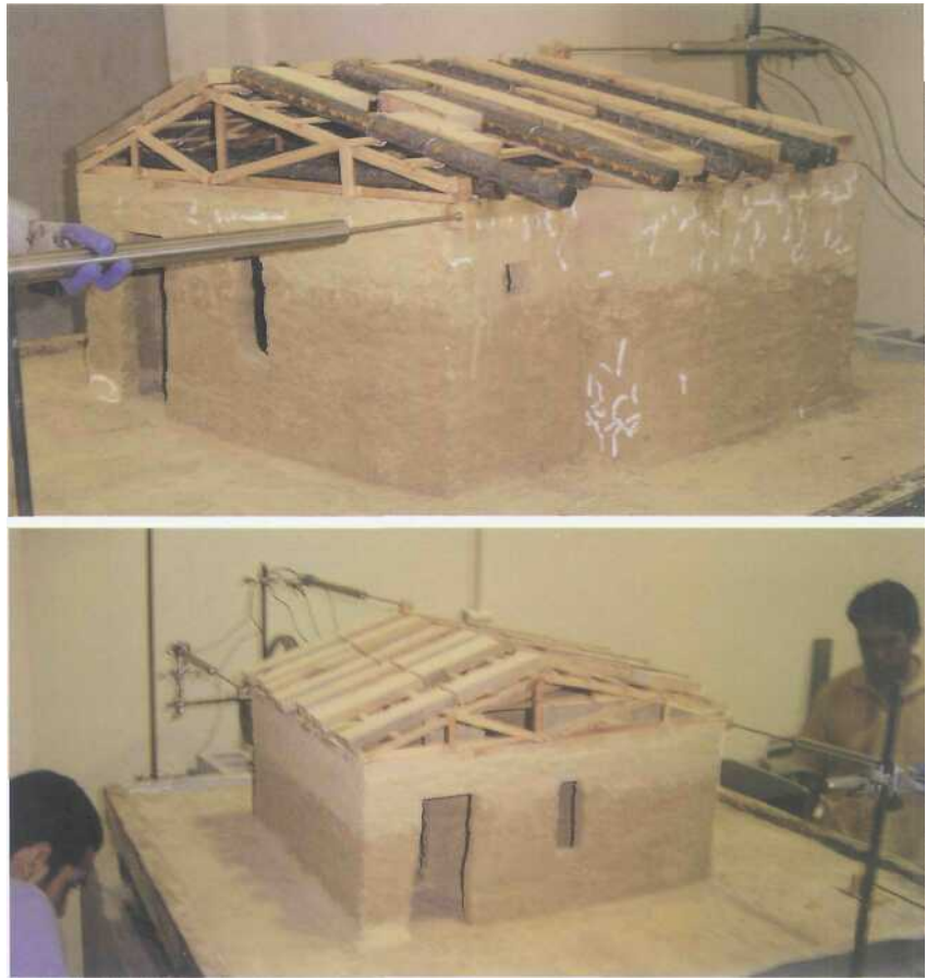
FIGURA 1 1 A. Vivienda a escala con sistema de aislamiento sísmico. 1B. Modelo de vivienda de adobe en mesa vibratoria.
