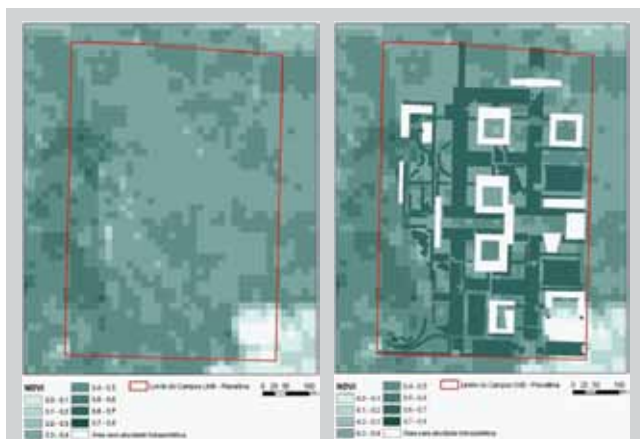
Fig. 9. Niveles de absorción de carbón, medido por NDVI, antes (izquierda) y después (derecha) de la implementación de las construcciones y del diseño del paisaje. Una ganancia en la absorción de carbono en promedio de un 7.09% fue detectada para presentes y futuras situaciones
