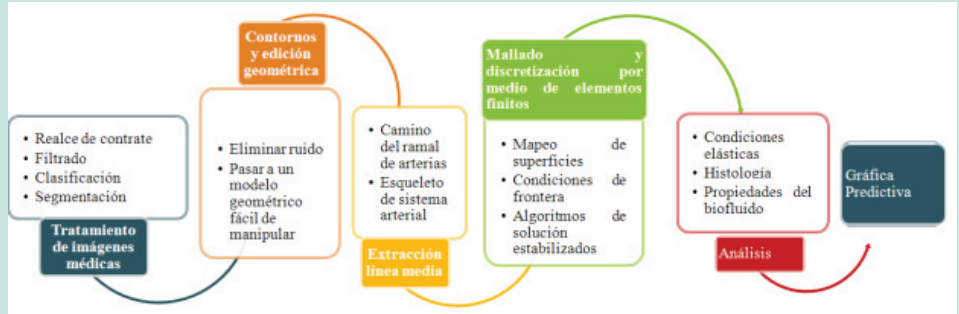
» Fig. 1. Metodología utilizada para obtener el modelo geométrico vascular y la predicción de su comportamiento.
