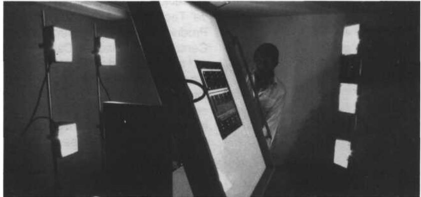
Toma de fotografía en negativo del diseño de un circuito impreso
