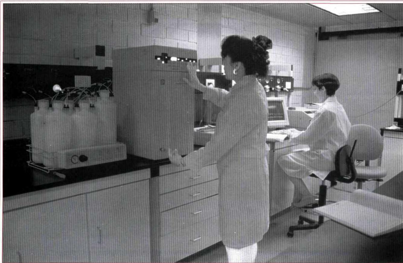
Análisis automatizado de agua. Técnica de cromatografía de iones
