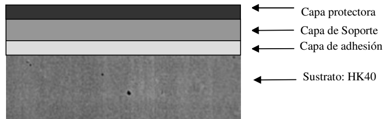
Figura 3.4 Arquitectura propuesta para el revestimiento protector contra la carburización.
