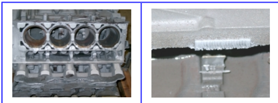
Figura 41. Cortes de mazarota y colada en Block GM V8 5.3 Lts mediante maquinado hidroabrasivo.
