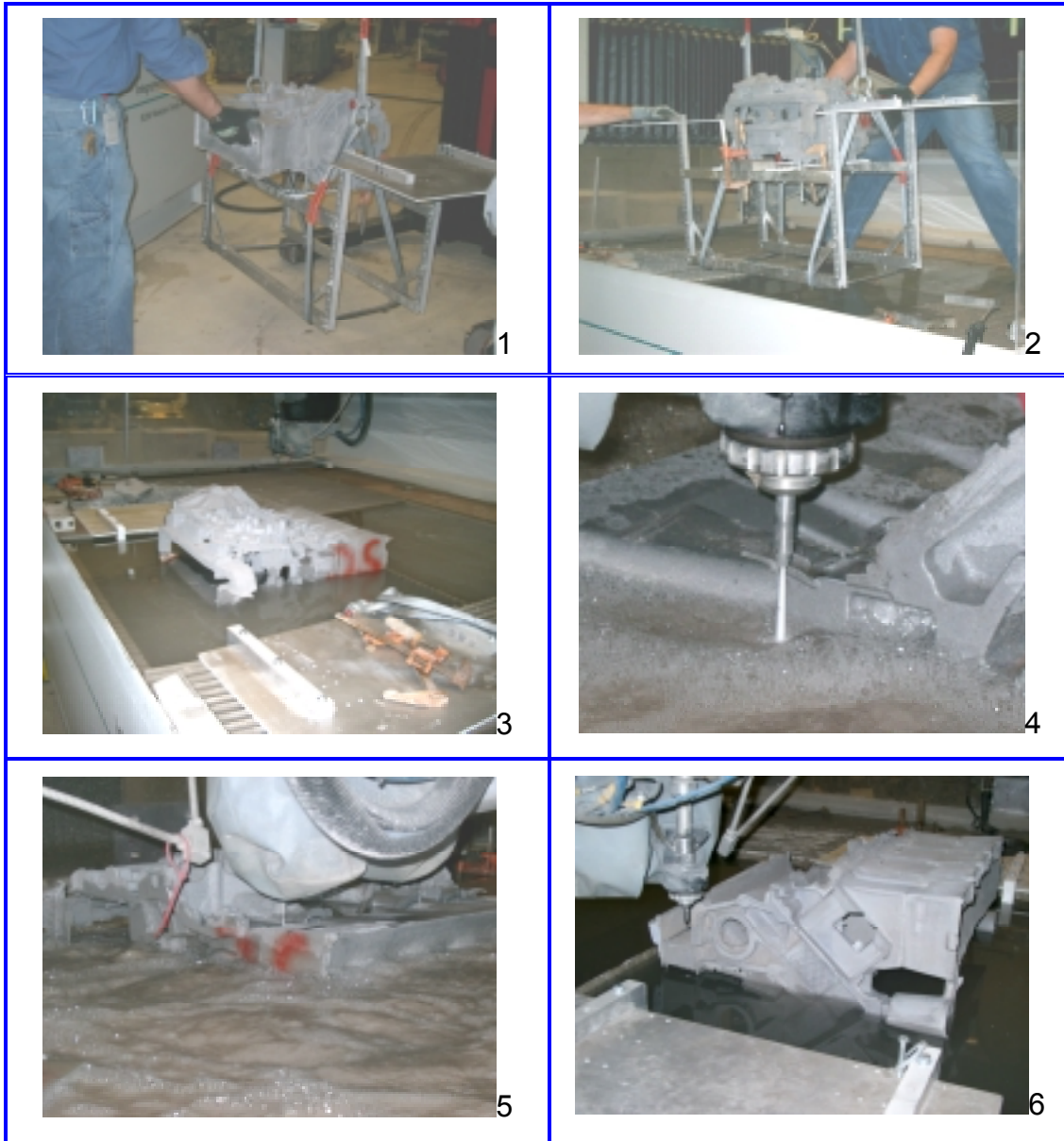
Figura 37. Secuencia de prueba para el corte de un Block I-4, V8 mediante maquinado hidroabrasivo.
