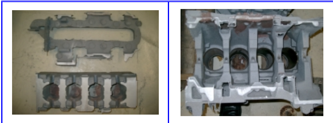
Figura 40. Cortes de mazarota y colada en Block Ford I-4 2.3 Lts mediante maquinado hidroabrasivo.
