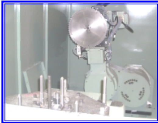
Figura 33. Sierra de disco Shiga Yamashita Modelo NMK-0228 y fixture con block Ford 4.6 Lts montado.
