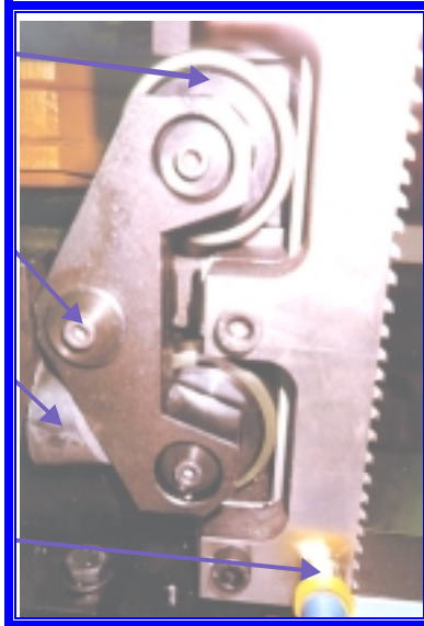
Figura 8. Arreglo de guía, roller y cinta de carburo de tungsteno.
