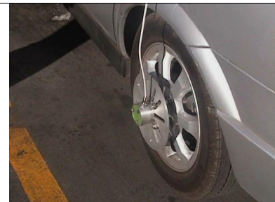
Fig. 3 Quinta Rueda: Instrumento desarrollado por el Centro de Investigaciones en Ingeniería Automotriz del ITESM para medir en forma independiente y confiable la distancia recorrida, la velocidad y la aceleración de los vehículos.
