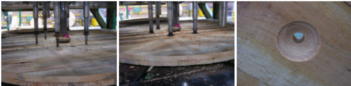
Figura 6.5.2.1 Proceso mejorado de perforación de cazuela
