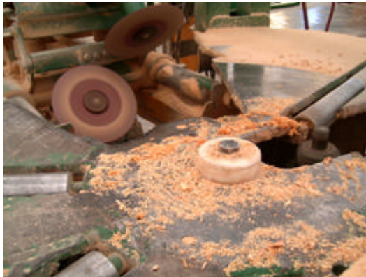
a) Estación para manufactura de router sin apoyo
