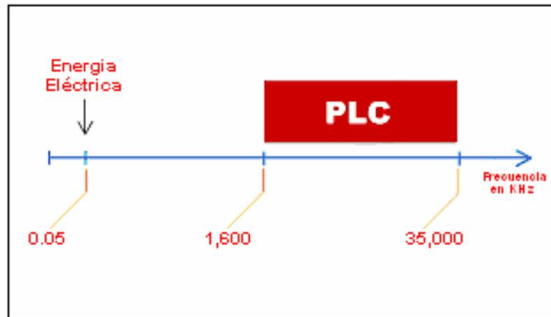
Por su parte, el equipo cabecera o Head End de la tecnología PLC, emite señales de baja potencia (50mW) en un rango de frecuencias que van desde 1.6 MHz hasta los 35 MHz, es decir en una frecuencia varios miles de veces superior a los 50 Hz en donde opera la energía eléctrica. Al otro extremo del medio de transmisión (el cable eléctrico) existe un receptor (equipo terminal) que es capaz de identificar y separar la información que ha sido transmitida en el rango de frecuencia indicado.
