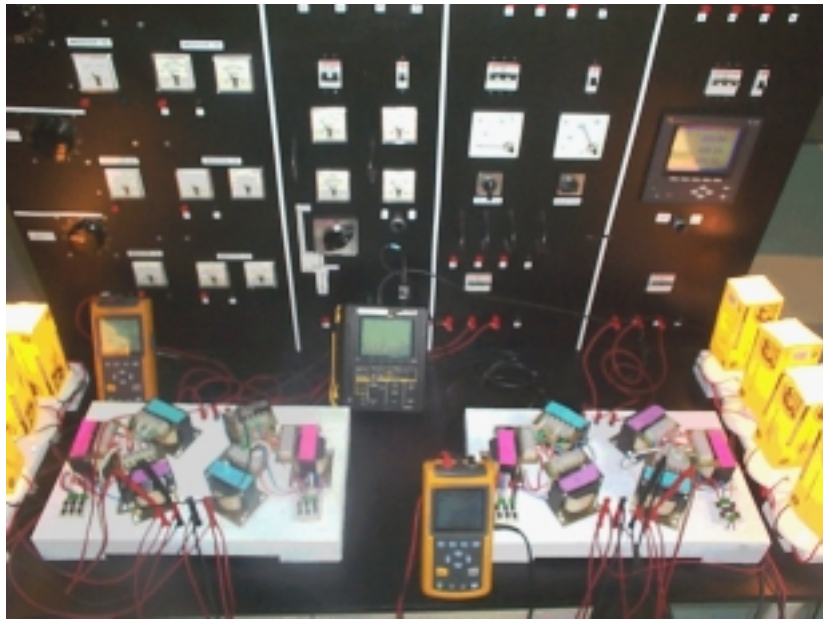
Figura 5.12 Rectificador de 24 pulsos no controlado
