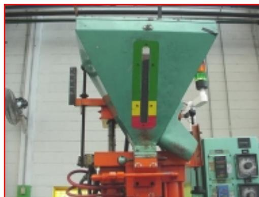
*Figuras 7 y 8-. Inyectora de Hule*
