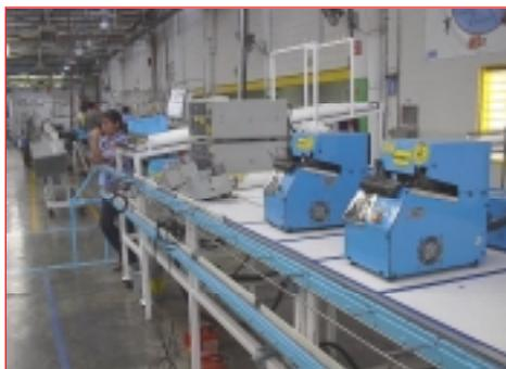
**Figura 6-. Horno de Termo Contracción de Aislante**
