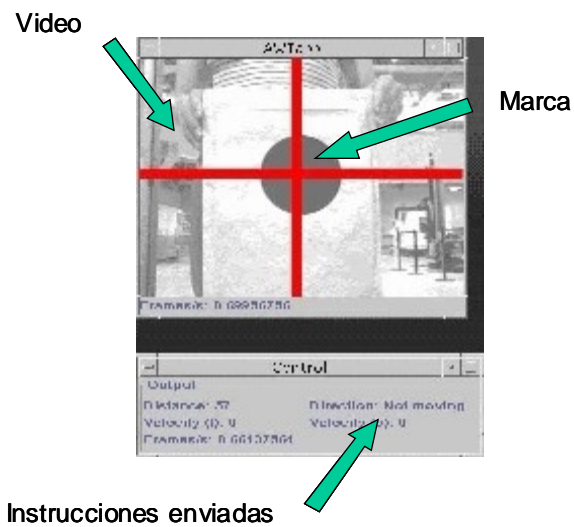
Figura 4.7: Interfaz utilizada en el Controlador Anfitrión durante la operación autónoma para asegurarse que la cámara vea la imagen completa
