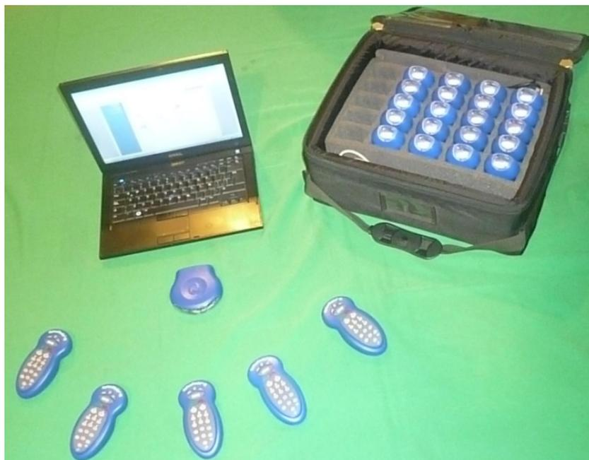
Figura 1.- Equipo de Option Power, consta de controles remotos, receptor y conexión a laptop.
