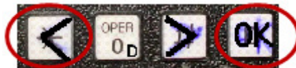
Figura 12-5. Al oprimir simultáneamente las dos teclas señaladas se entra a la sección de ajustes.
