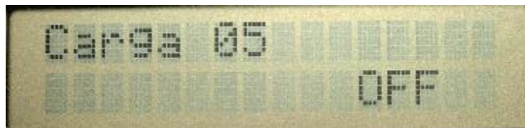
Figura 7-23. Carga 5 se encuentra apagada en forma manual.
