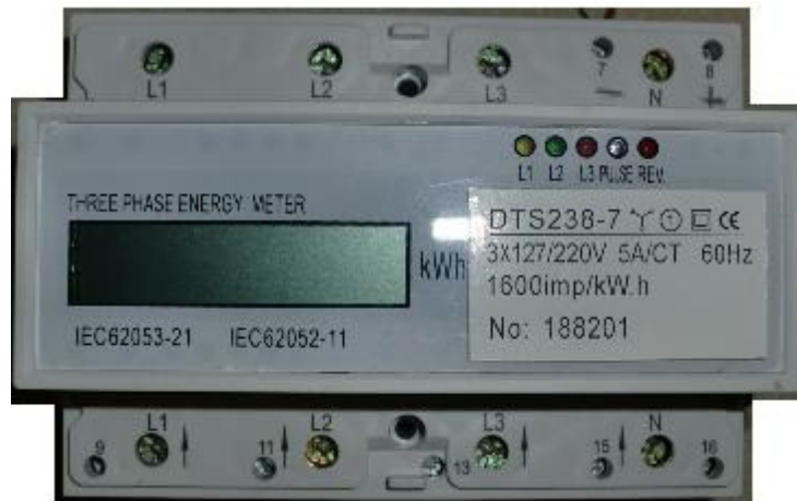
Figura 6-3. Medidor trifásico de energía utilizado en el proyecto.
