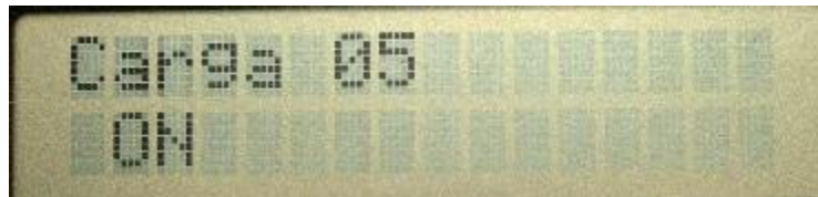
Figura 7-22. Carga 5 se encuentra encendida en forma manual.
