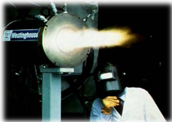
Foto 4.1 Las antorchas de plasma son aparatos sofisticados, pero su objetivo es simple. Las antorchas son dispositivos de alta temperatura.
