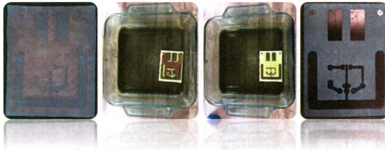
Figura 4.25: Proceso de impresión en placa fenólica (izquierda a derecha)
