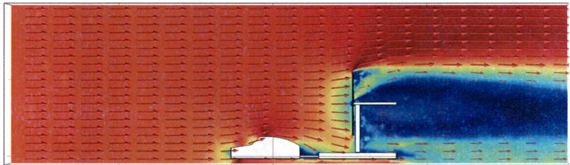
Figura 4.10: Simulación del modelo con semi-perfil en COMSOL.
