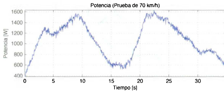
Figura 5.24: Serie de tiempo de la potencia (70 km/h)
