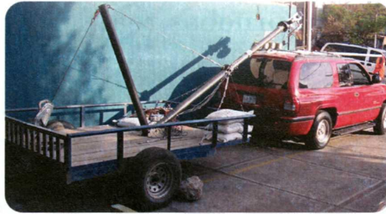
Figura 4.14: Remolque modificado con mástil y generador
