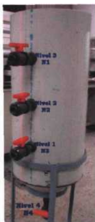
Figura 3.7. Sedimentador sobre base
