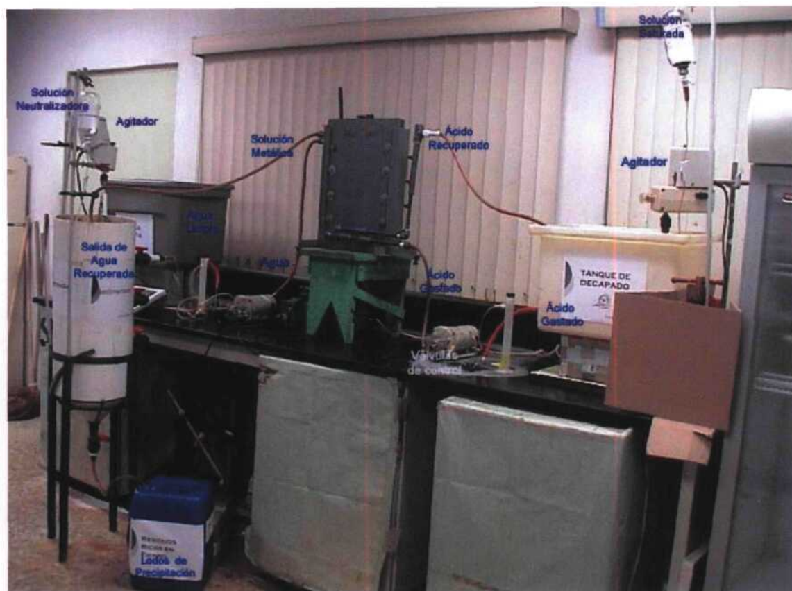
Figura 3.8. Sedimentador integrado al sistema de decapado en continuo
