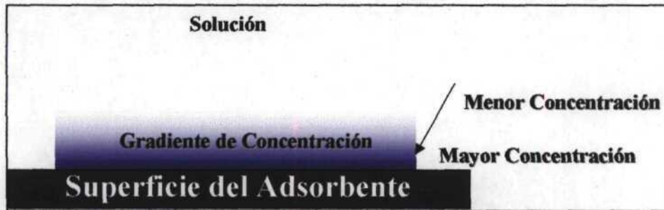
Figura 11. Diagrama de concentración en la superficie del adsorbente
