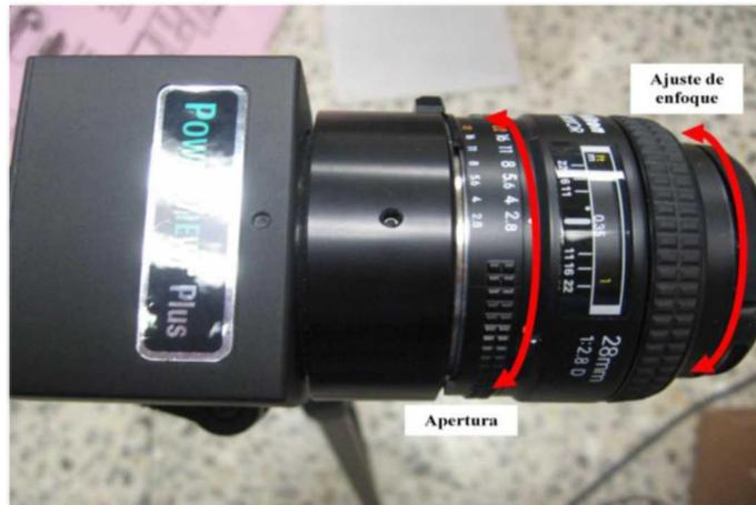
Figura IX.7. Apertura y enfoque de la cámara.
