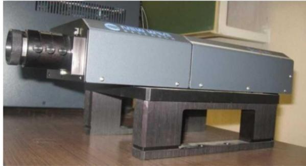
**Figura II.3. Láser de luz para iluminar partículas.**
