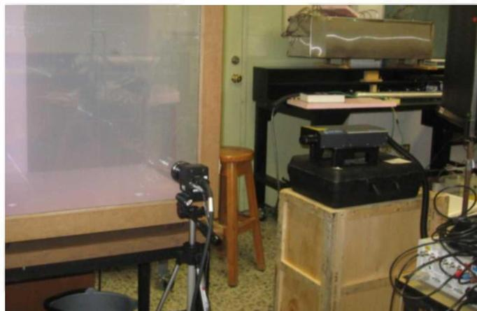
**Figura IV.9. Alineación del láser con respecto a la cámara.**
