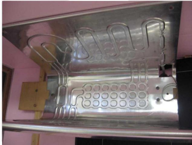
Figura IV.4. Evaporador de aluminio.
