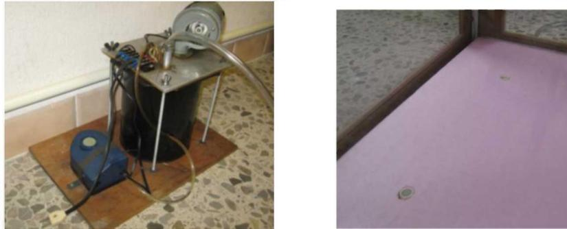
Figura IV.2. Generador de humos habilitado y entradas del humo en la parte inferior.
