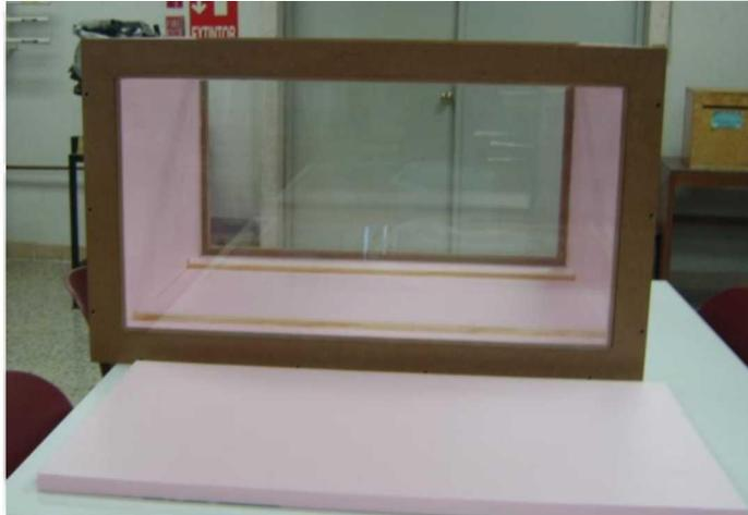
**Figura IV.1. Construcción de cavidad con aislante interno**
