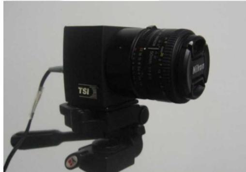
**Figura II.5. Cámara CCD.**
